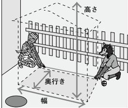
設置場所の幅・奥行・基礎ブロック込みの高さが設置の基準となります。
