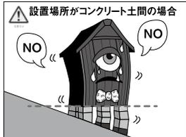
必ず整地工事をしてから設置してください。（傾斜部分から50cmは離すこと）。傾斜部分ギリギリの設置は危険な為、お受けできない場合があります。
