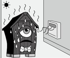
排気口付近には設置しないでください。（変色やサビの原因になります。）外気温、直射日光により、物置外部が熱くなります。
