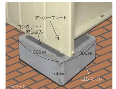
マスアンカー寸法300mm×300mm×150mmで1ヶ所約45kg(4ヶ所で約180kg)。通常は4コーナーのアンカー工事になり2ヶ所のみなどの施工は安全上お受けできません。ゴムマットを敷くのでタイルや石貼りコンクリートは接着いたしません。高さ150mmになる為、他の位置には市販の半ブロックを使用。
