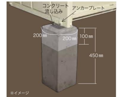
束石寸法200mm×200mm×450mmです。強風地用に対応。1ヶ所の重量約60kg(4ヶ所で約240kg)になります。4コーナーのアンカー工事になり2ヶ所のみなどの施工は安全上お受けできません。他の位置には10cmのコンクリートブロックを使用。
