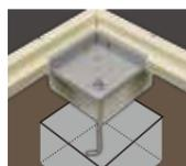
布基礎と本体を固定するため、物置の内部に内アンカー工事を行います。
