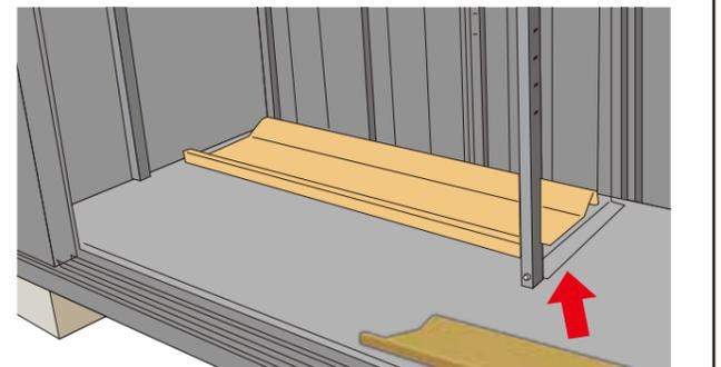
床パネルや棚板の上面に置くだけでタイヤを安心して収納できます。棚板の上には5ナンバー車用タイヤサイズφ60cm 4本迄可能。床板面にはサイズの制限はありません。
