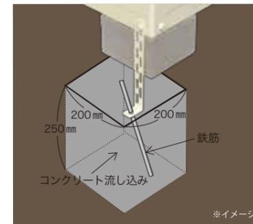
土アンカー寸法200mm×200mm×250mmで鉄筋差し込み施工です。一般地用に対応。1箇所の重量約20kg(4ヶ所で約80kg)になります。4コーナーのアンカー工事になり2ヶ所のみなどの施工は安全上お受けできません。
