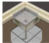
ブロック基礎と本体を固定するため、物置の内部に内アンカー工事を行います。
