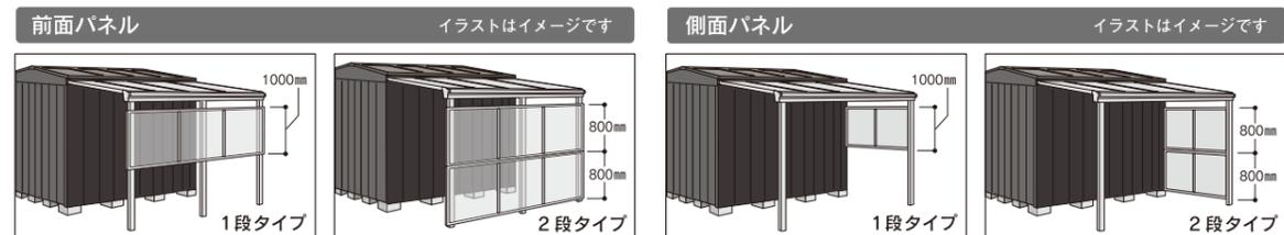
※前面側面共に1段タイプの場合は縦1000mm、2段タイプの場合は縦1600mm ※奥行2200タイプの場合、イラスト左のように間柱が1本入ります。
